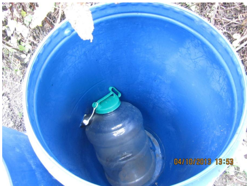
სურ. 7. საკვლევი პოლიგონის ქვევით განთავსებულ დიდ რეზერვუარებში მოთავსებული მცირე მოცულობის ნატანმიმღები კასრები
