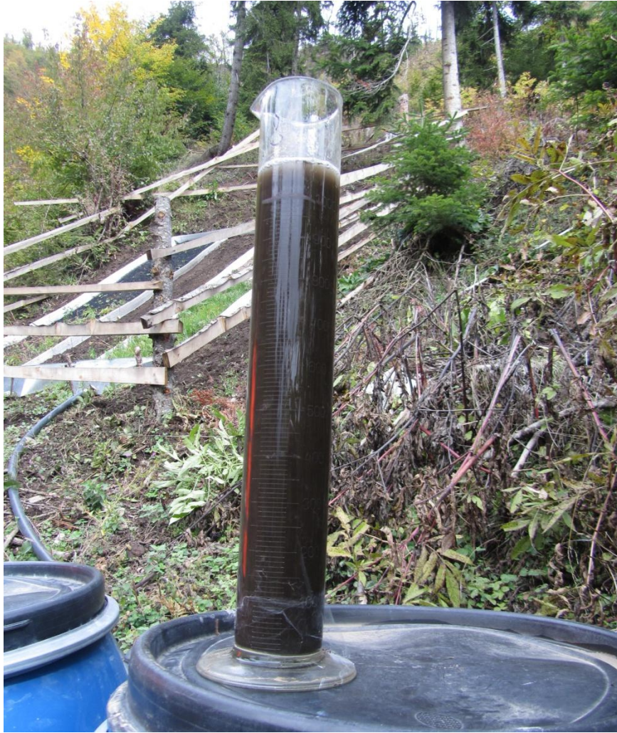
სურ. 9. ნატანმიმღები რეზერვუარიდან აღებულ სინჯში მიმდინარე მყარი ჩამონადენის დალექვის პროცესი
